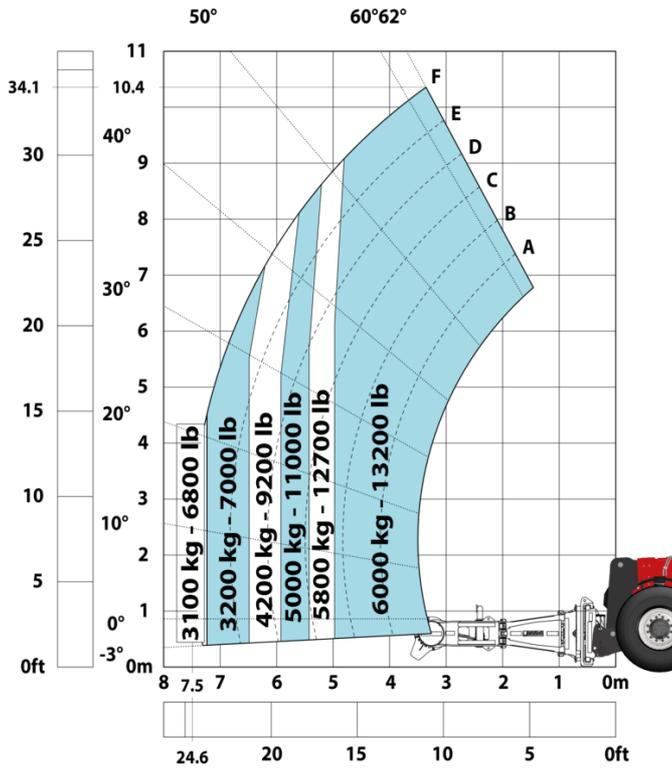
Máquina sob rodas com manipulador de cilindros CH10 (Métrico)
