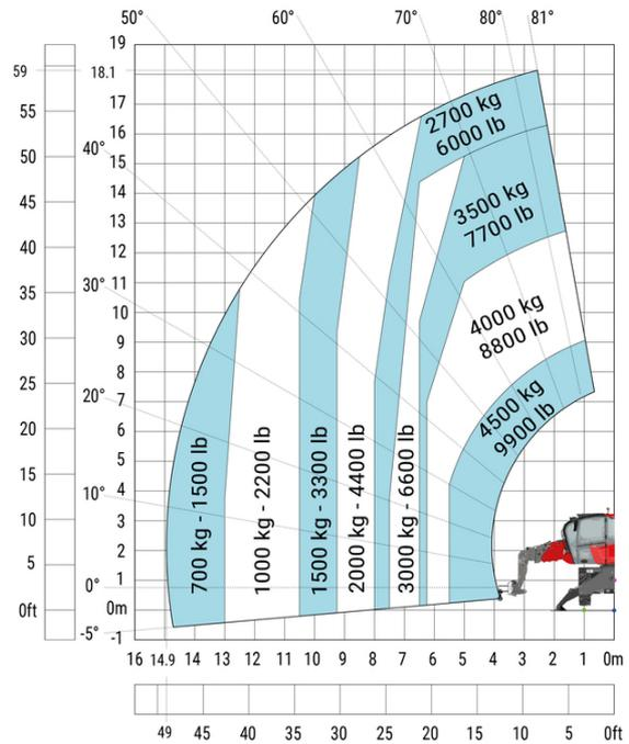
Rotación sobre estabilizadores bajados con plataforma de 365 kg      Rotación sobre estabilizadores bajados, con plataforma de 1.000 kg
