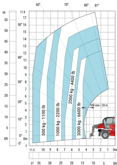
Rotación sobre estabilizadores bajados, con horquillas
