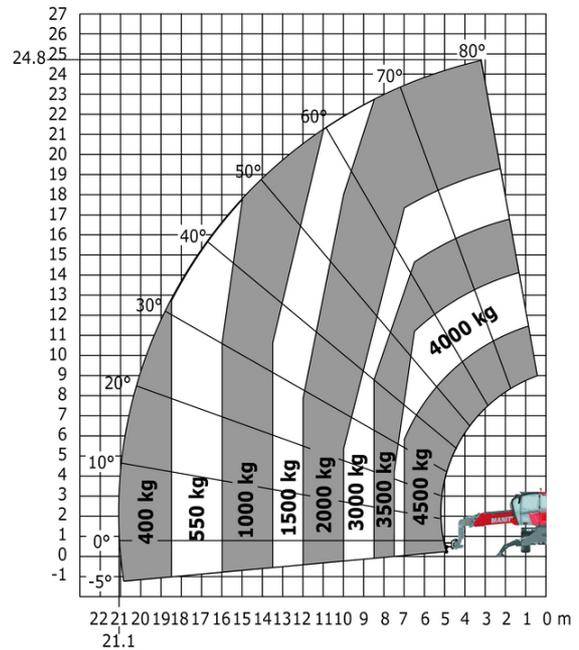
Rotación sobre estabilizadores bajados con plataforma de 365 kg      Rotación sobre estabilizadores bajados, con plataforma de 1.000 kg
