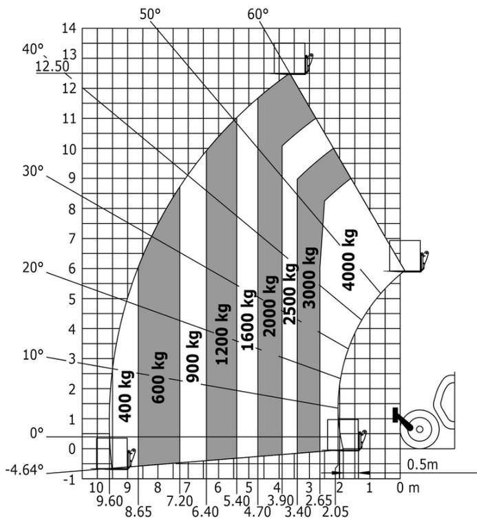
Drehung mit abgesenkten Stützen mit Gabeln
