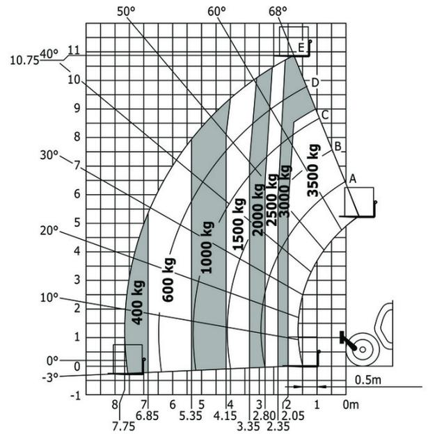
Rotación sobre estabilizadores bajados, con horquillas
