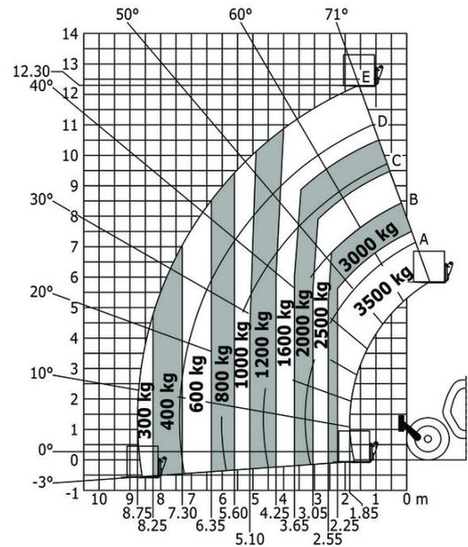
Drehung mit abgesenkten Stützen mit Gabeln
