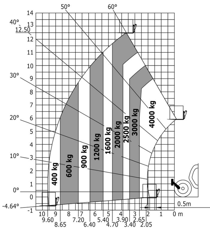
Drehung auf abgesenkten Stützen mit Gabeln
