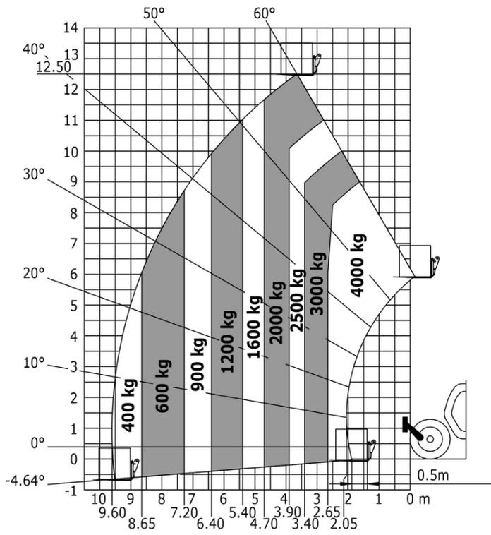
Rotación sobre estabilizadores bajados, con horquillas
