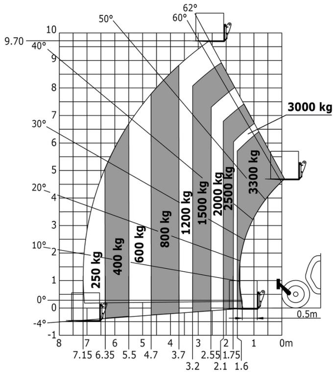
Rotación sobre estabilizadores bajados, con horquillas
