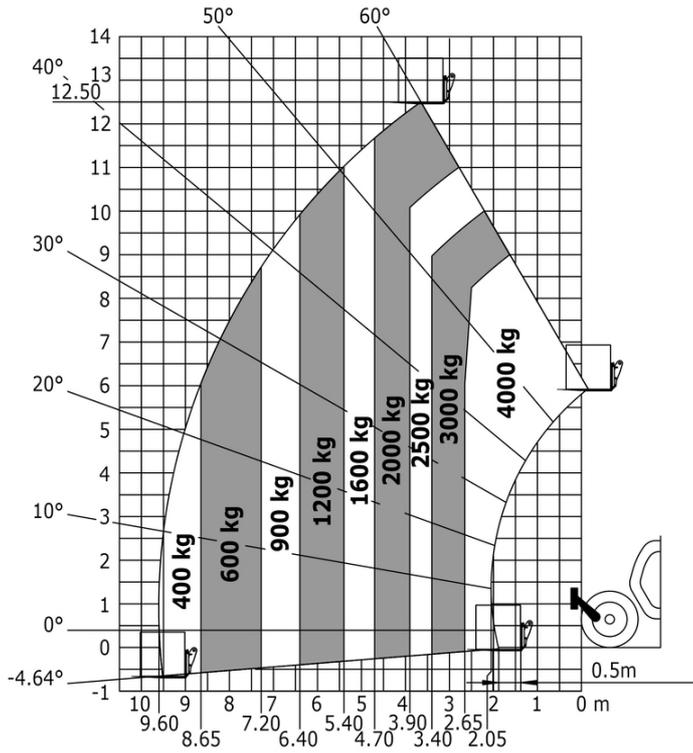
Drehung auf abgesenkten Stützen mit Gabeln
