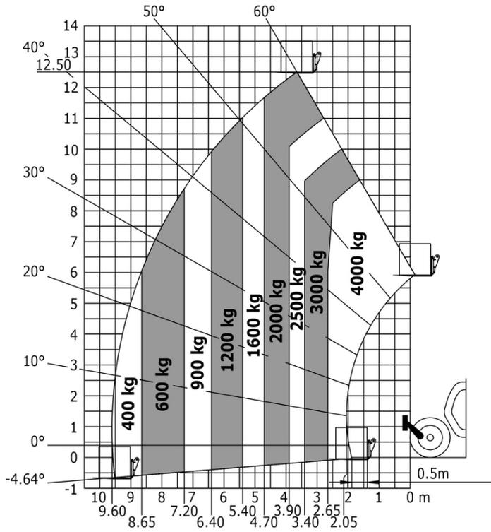
Drehung mit abgesenkten Stützen mit Gabeln
