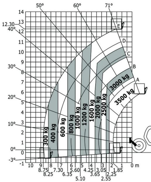
Drehung mit abgesenkten Stützen mit Gabeln
