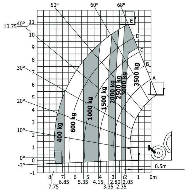
Rotación sobre estabilizadores bajados, con horquillas
